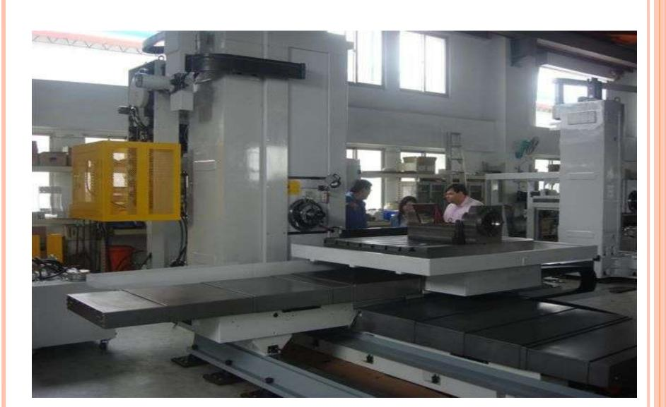
X - 2000MM, Y - 1600MM, W - 500 MM, Z - 2500MM SPINDLE DIA.- 110MM, CONTROLLER 18 IMB, SIMULTANEOUS 4 AXIS 28 ATC
